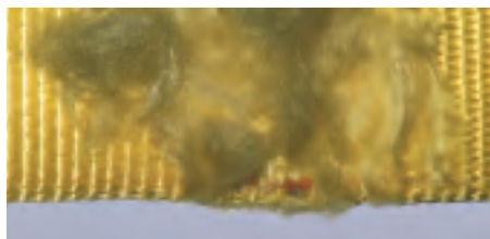
Desgaste excesivo por abrasión
