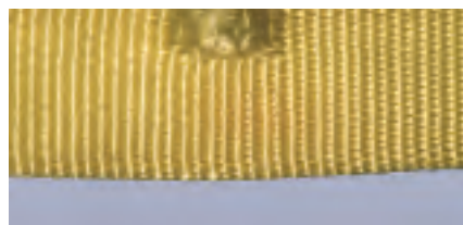
Agujeros, desgarramientos, cortes, rasgaduras
